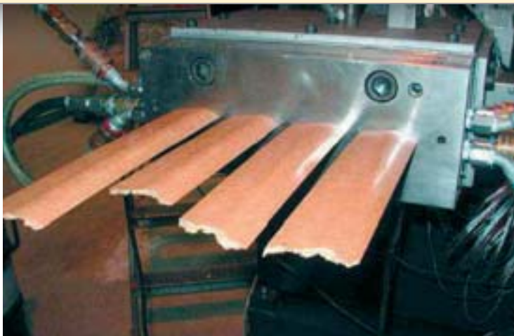
Procédé d'extrusion (sources : Fasalex, Technoplast)
