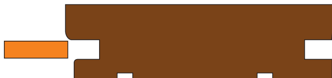
Élément de type 2 : à rainure et fausse languette
